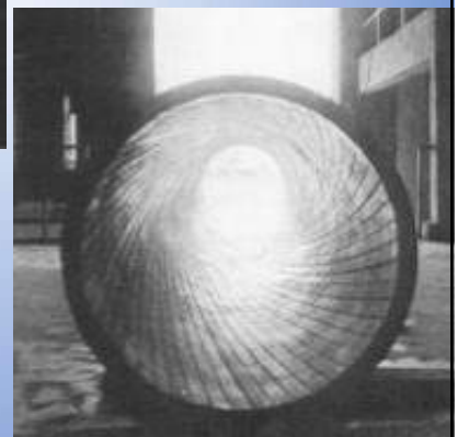
Vue frontale d'un tel tuyau précontraint
